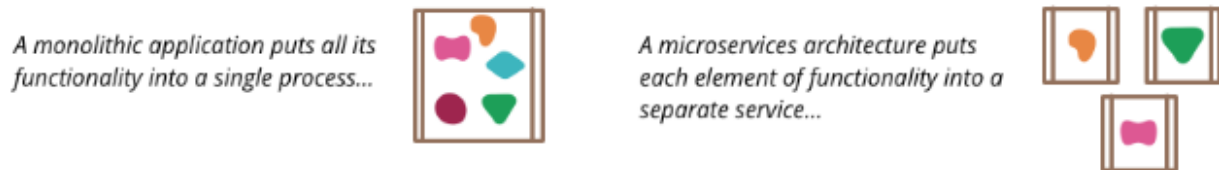
ABBILDUNG 2.2: Konzeptioneller Vergleich eines Deployment-Monolithen und Microservices aus Prozesssicht (Quelle: Fowler, Microservices )
